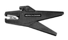
Automatische Abisolierzange für isolierte Leitungen (flexibel) 0,08 - 6mm2. Mit Kabelschneider bis 6mm², Längenanschlag und Einstellmöglichkeit der Abisolierlänge.
